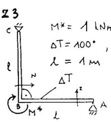
$M^*=1\text{ kNm}, E=2 \cdot 10^5\text{ MPa}, \alpha_T=1.25 \cdot 10^{-5} \frac{1}{^\circ\text{C}}$
