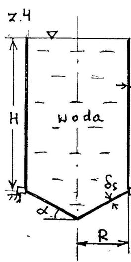
$R=1\text{ m}, H=4\text{ m}, \gamma=10^4\text{ N/m}^3$
