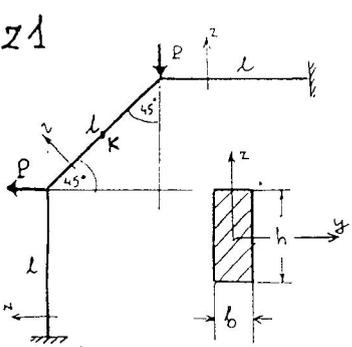
Wyznaczyć i narysować przebiegi sił wewnętrznych w pokazanej na rysunku ramie. Wyznaczyć i narysować rozkład naprężenia normalnego od zginania w najbardziej niebezpiecznym przekroju. Obliczyć obrót przekroju K.
